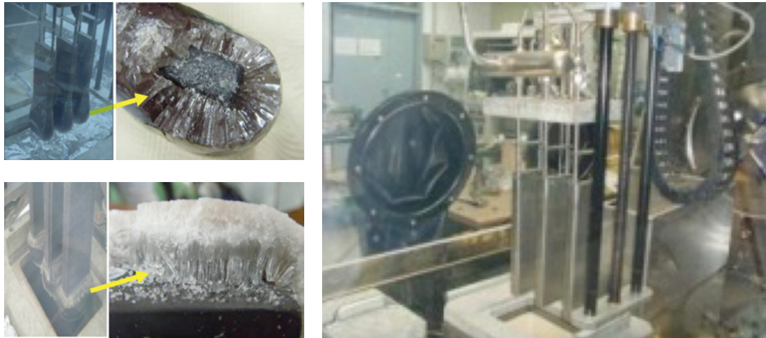
ABBILDUNG 36 Kristallbildungsmerkmale an der Außenfläche des Kristallisators.
