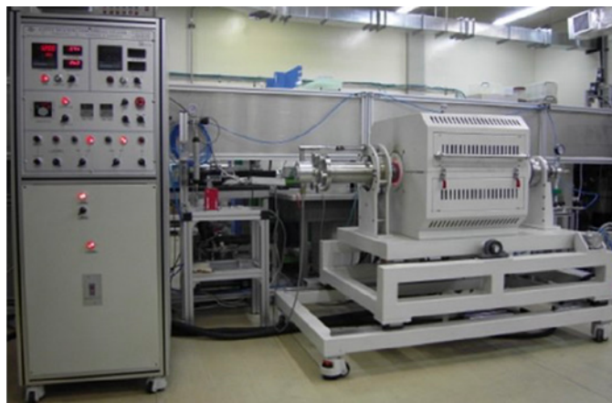
ABBILDUNG 16 Foto eines Voloxidationsgeräts in PRIDE bei KAERI®.
